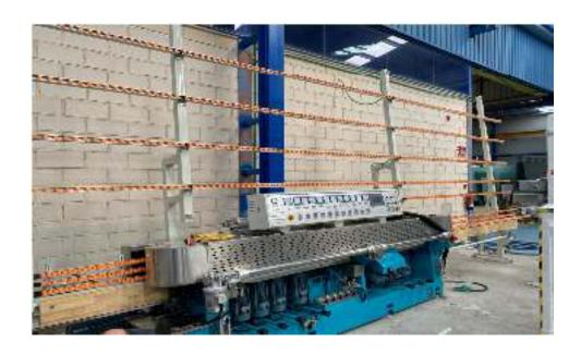
Esta máquina está recomendada para procesar piezas grandes y pesadas, debido a su sólida estructura y su sistema de rodamientos de bolas, así como los motores ABB de alta precisión.
