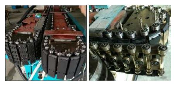
Los cojinetes tanto para el tapete delantero como para el trasero están lubricados por sendas bombas de aceite en la parte superior de transporte, el sistema de lubricación permite que los cojinetes , tanto el superior como el inferior reciban el aceite de manera constante.
